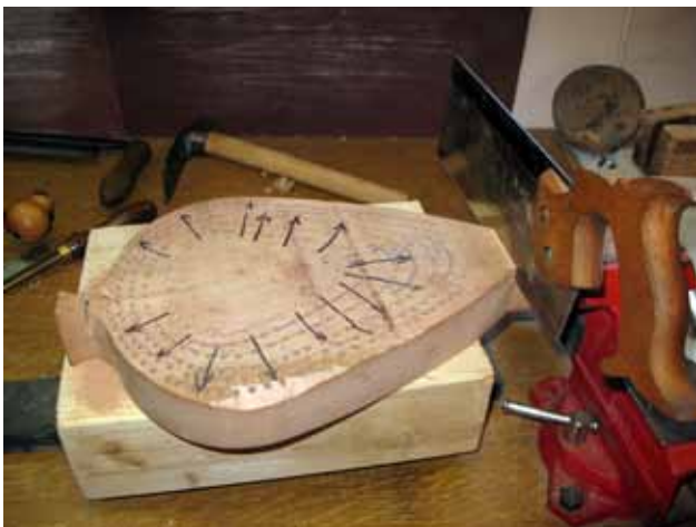
Εικόνα 7.20. Η έναρξη της διαμόρφωσης της πλάτης του σκάφους, με τομές στη βάση της ουράς και του λαιμού.
