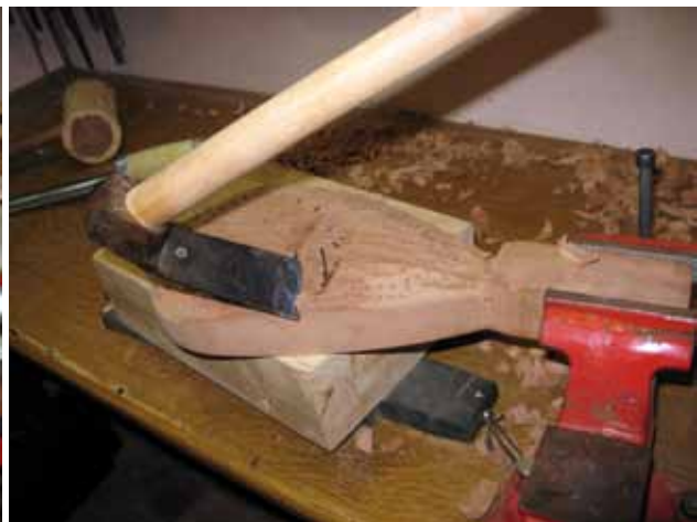
Εικόνα 7.21. Η πρώτη φάση της διαμόρφωσης της πλάτης με σκεπάρνι.
