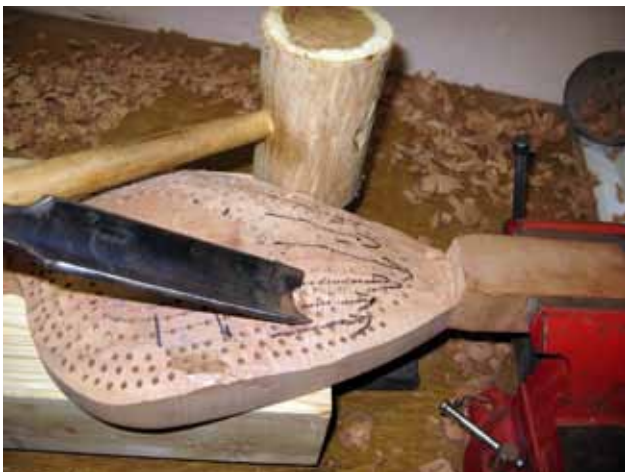
Εικόνα 7.22. Η δεύτερη φάση διαμόρφωσης της πλάτης με μεγάλο γλύφανο και ματσόλα.
