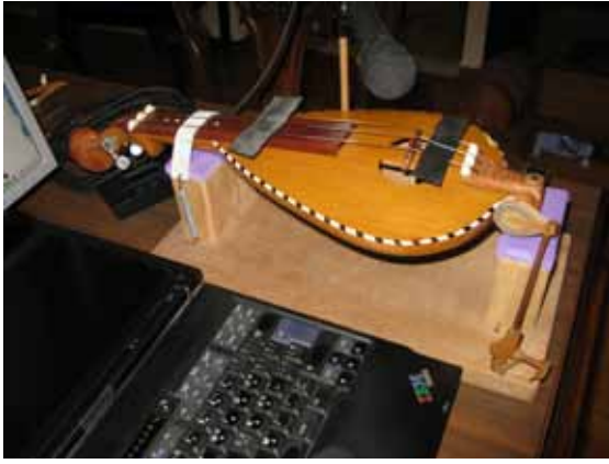
Εικόνα 7.96. Το όργανο τοποθετημένο στην ειδική βάση και με μονωμένες τις χορδές, για την καταγραφή της καμπύλης κρουστικής απόκρισης του οργάνου.
