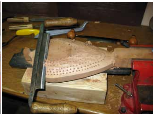
Εικόνα 7.23. Η τρίτη φάση διαμόρφωσης της πλάτης με το ροκάνι του γύφτου.
