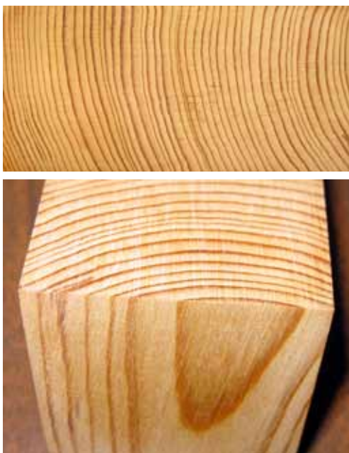
Εικόνα 5.3. Δακτύλιοι ανάπτυξης σε τομή εγκάρσια (επάνω) και εγκάρσια-εφαπτομενική (κάτω), κέδρου Λιβάνου (κατράνι). Οι σκούροι δακτύλιοι είναι το όψιμο ξύλο ενώ οι ανοιχτόχρωμοι το πρώιμο.
