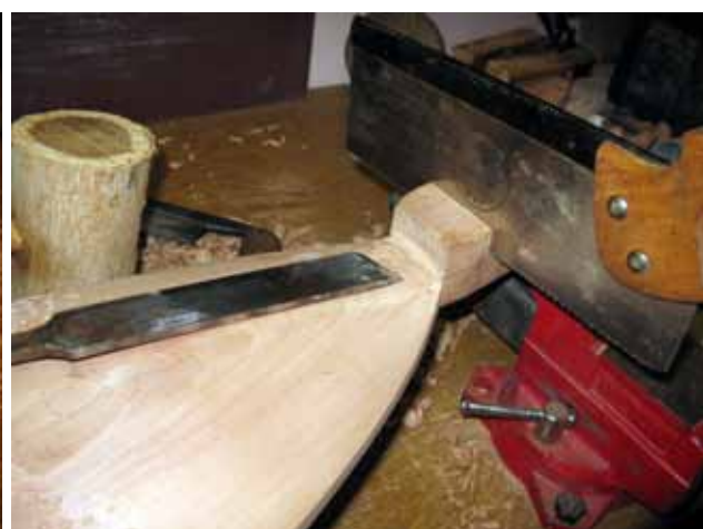
Εικόνα 7.25. Η αφαίρεση του ξύλου από τη βάση του λαιμού για την ολοκλήρωση της διαμόρφωσης της πλάτης του σκάφους.
