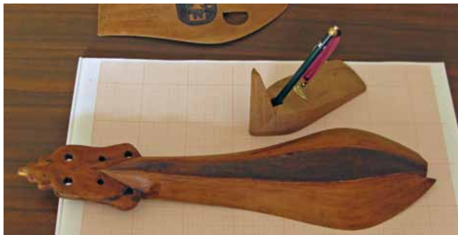
Εικόνα 3.1. Η μέθοδος αντιγραφής του περιγράμματος της πρόσθιας όψης του οργάνου σε χιλιοστομετρικό χαρτί. Το εικονιζόμενο εργαλείο χάραξης των ορίων είναι ιδιοκατασκευή.
