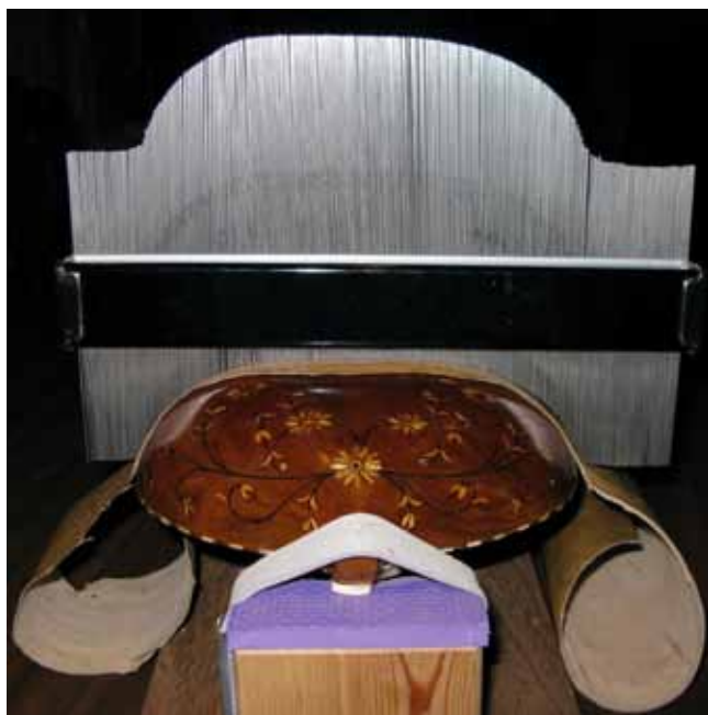
Εικόνα 3.2. Η μέθοδος αντιγραφής της εγκάρσιας τομής του οργάνου.
