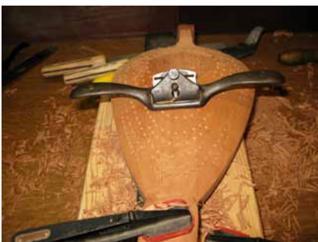
Εικόνα 7.24. Η αρχή της τελικής φάσης διαμόρφωσης της πλάτης με παστράγκολο.
